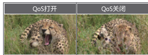
以上示例显示了在15%丢包率的情况下, 使用和不使用QoS功能进行现场实时流媒体传输的画面。
